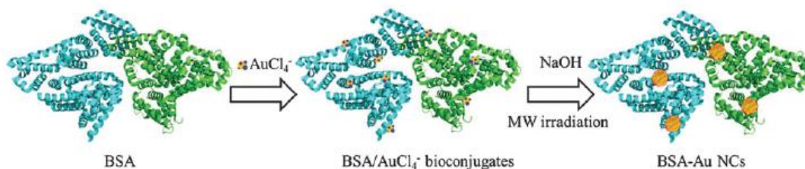
Obr. 3. Schéma syntézy zlatých nanoklastrů s BSA – převzato z literatury [16].
