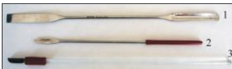
Obr. 3: Kopist 1 – kovová dvojitá, 2 – kovová jednostranná, 3 – skleněná
